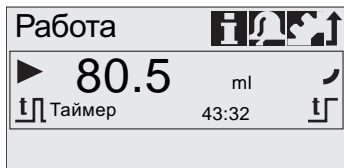
Рис. 29 Ежедневное дозирование по таймеру (перерыв в дозировании)
